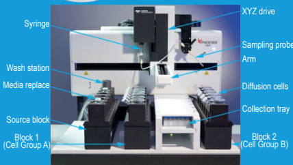
Phoenix Dry Heat Diffusion Cell
