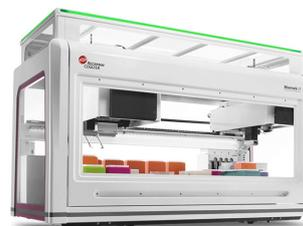
Plataforma robótica de manipulação de líquidos, **Biomeki5**, capaz de ter um braço com uma cabeça de 8 pontas expansíveis ou uma cabeça multicanal de 96 pontas ou 384 pontas e com suas 25 posições de trabalho, tem capacidade para produzir 7 placas Placas AMPureXP ou 2 RNAdvance sem intervenção do utilizador
