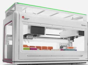
Plataforma robótica de manipulação de líquidos, **Biomek i7** híbrido, com cabeça multicanal de 96 pontas, 8 pontas expansíveis entre si e gripper em cada braço. Com 35 posições de trabalho, é capaz de produzir 10 placas AMPureXP ou 4 placas RNAAdvance sem intervenção do utilizador
