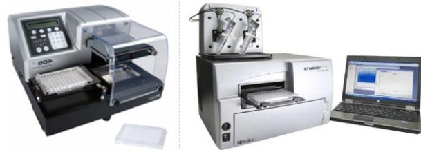
Lavador de microplacas 405LS e Synergy HTX com injetores, instrumentação para desenvolver ensaios ELISA com leituras de absorvância ou fluorescência, um primeiro passo na automação
